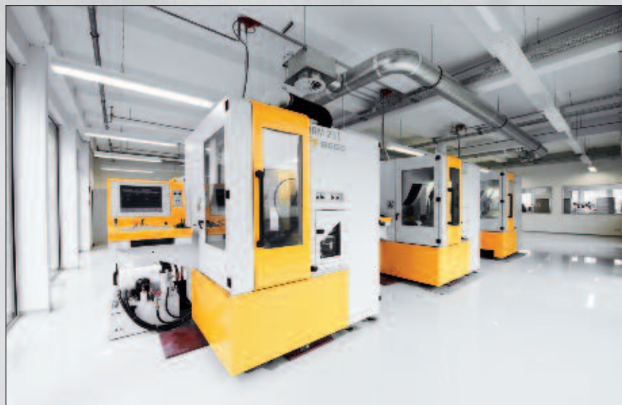
► Abb. 20 Produktionszentrum Bego Medical mit Fräsmaschinen zur subtraktiven Bearbeitung von Keramiken, Metallen und Kunststoffen
