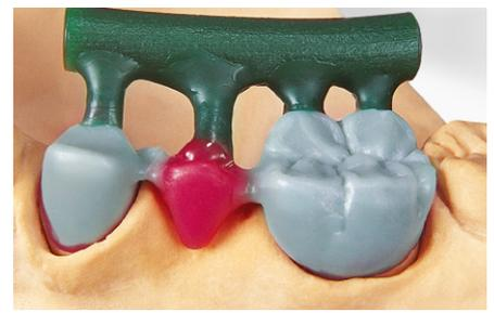
Gusskanäle mit Verteilerkanal
