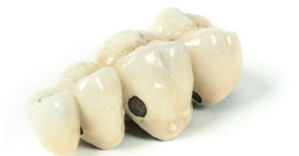
Blasen in der Keramik und unzureichender Keramikverbund mit dem Gerüst aufgrund unzureichenden Trocknens des Pastenopakers
