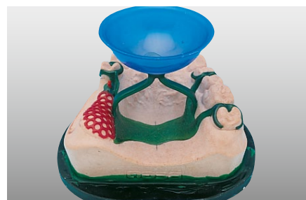
Ansetzen der Gusskanäle im Oberkiefer Guss von oben
