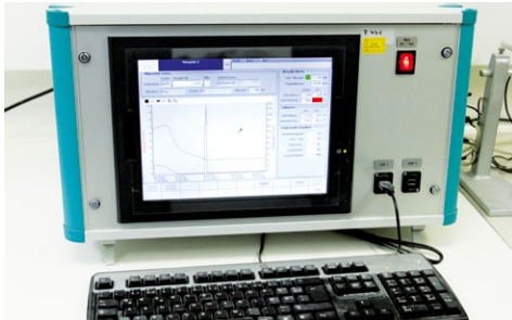
Qualitätskontrolle mit modernsten Geräten: Das Dilatometer ermittelt die thermische Expansion der BEGO Einbettmassen
