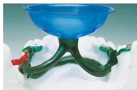
Ansetzen der Gusskanäle im Unterkiefer, Guss von oben
