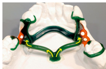
Guss durch das Modell, Gusskanäle gebogen ansetzen
