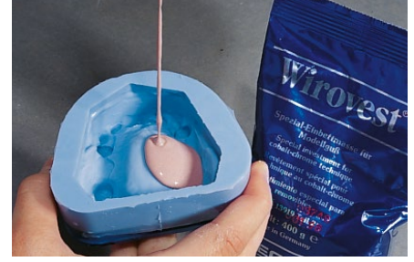
Einfüllen der Modellguss-Einbettmasse
