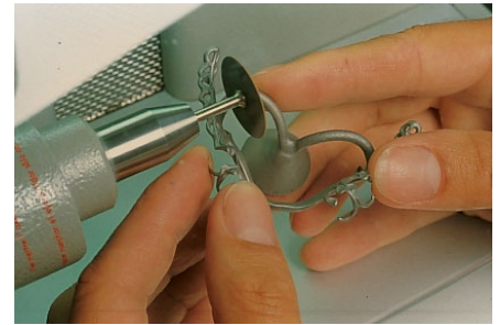
Abtrennen der Gusskanäle
