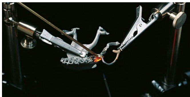
Anlöten einer konfektionierten Goldklammer
