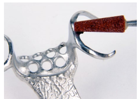
Ausarbeiten mittels Korund- bzw. Feinschleifkörper
